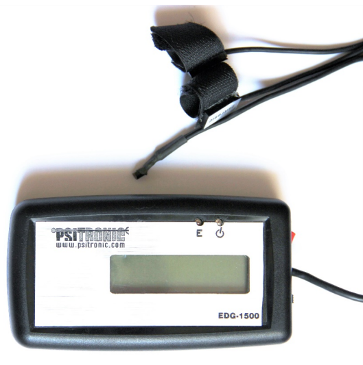
Figura 1. Electrotermodermómetro marca Psicotronic EDG-1500, utilizado para la medición de la respuesta eléctrica de la piel y la temperatura corporal periférica.
